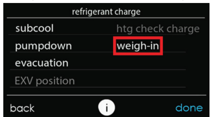
Fig. 16 – Option de pesée pour une charge à température ambiante extérieure inférieure à 18 °C (65 °F) ou supérieure à 41 °C (105 °F) A20034
