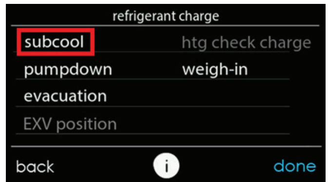
Fig. 13 – Sélectionner le sous-refroidissement de frigorigène A20031
